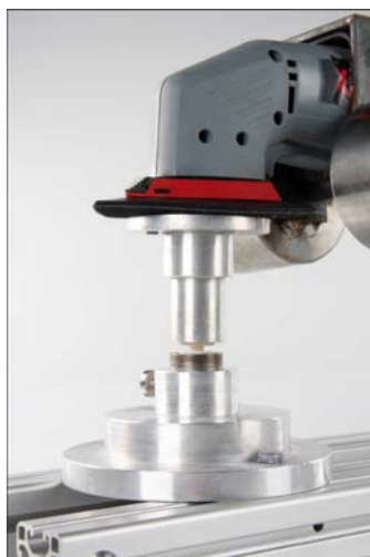
Abbildung 5 zeigt die Art des Kontaktes zwischen Probe und Reibkörper.
